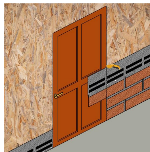
Рис. 31. Монтаж фасадной плитки вокруг дверного проёма.
