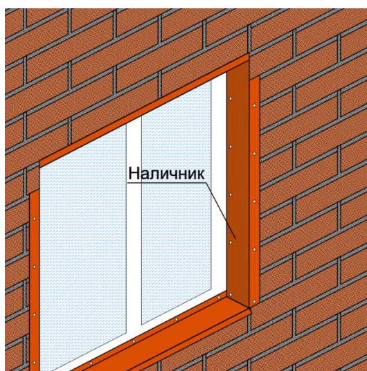
Рис. 29. Обрамление оконного проёма при помощи наличника (тип 4, таблица №2).
