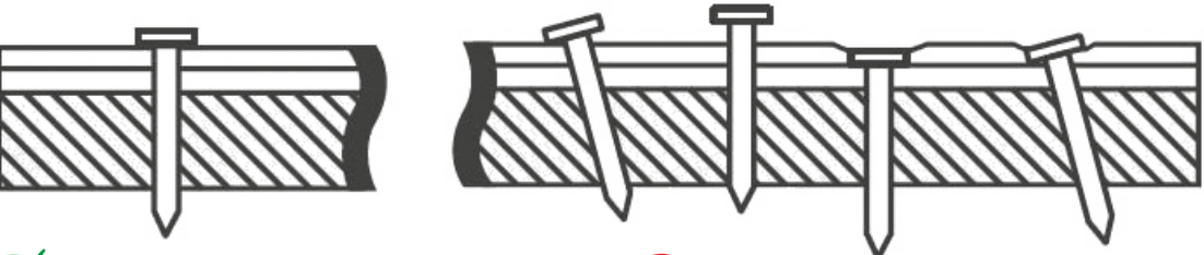
Рис. 3. Пример правильной забивки гвоздей при монтаже продукции.
